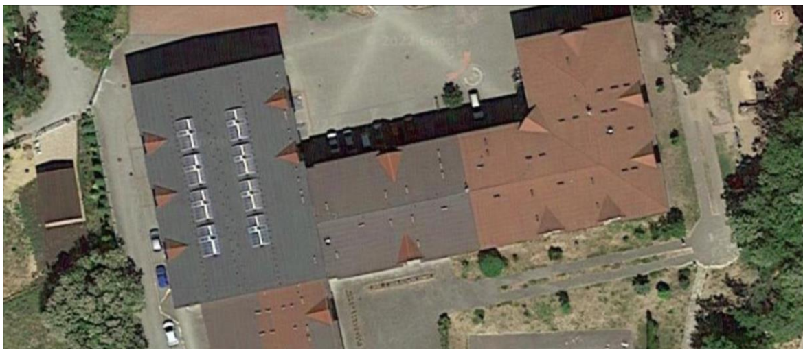
Rys. 31 Widok satelitalny połaci dachowych SP w Straszynie predestynowanych do zabudowy modułami fotowoltaicznymi.
