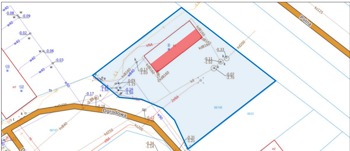
Rys. 56 Kopia mapy zasadniczej dz. 220404_2.0010.AR_2.66/148 z oznaczonym na czerwono obszarem zabudowy modułami.
