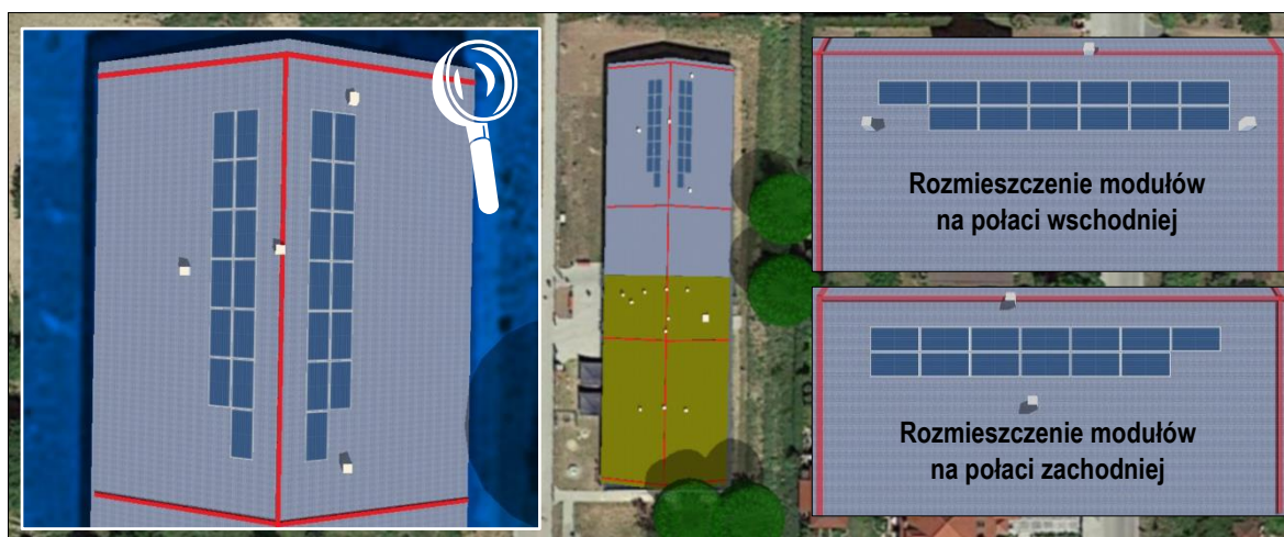
Rys. 29 Propozycja zakresu prac w ramach zamierzenia w obrębie połaci dachowych Gminnego Przedszkola w Straszynie.
